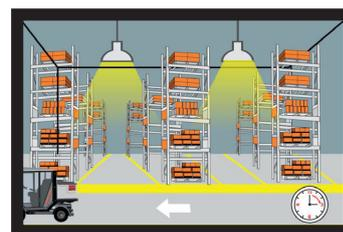
✓Après le temps d'allumage, en absence de mouvements, le détecteur passe en période de veille avec un abaissement du flux lumineux au seuil fixé.
