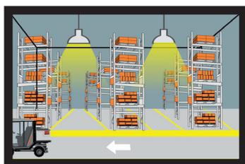
✓En l'absence de mouvements dans la zone de détection, le luminaire reste en mode veille au seuil de luminosité fixé.
