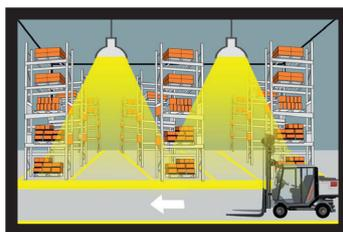
✓Lorsqu'un mouvement survient dans la zone de détection, le détecteur allume le luminaire à 100% de sa puissance
