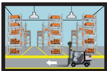
Avec une luminosité ambiante suffisante, le détecteur n'allume pas le luminaire lorsqu'un mouvement survient dans la zone de détection.
