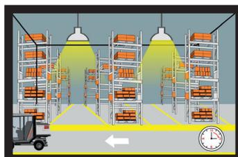
Après le temps d'allumage, en l'absence de mouvements, le détecteur passe en période de veille avec un abaissement du flux lumineux au seuil fixé.
