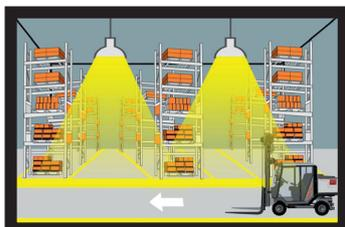
Avec une luminosité ambiante insuffisante, le détecteur allume le luminaire lorsqu'un mouvement survient dans la zone de détection.
